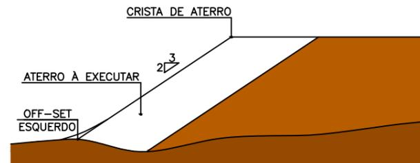
**2ª FASE** CORTE DA SAIA E REGULARIZAÇÃO DO TERRENO NATURAL. COMPACTAÇÃO DA CAMADA. NA EXECUÇÃO DA 1ª CAMADA DE REGULARIZAÇÃO SOBRE O TERRENO NATURAL SERÁ PERMITIDA UMA ALTURA DE 40cm APÓS COMPACTAÇÃO.
