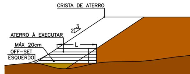
**4ª FASE** EXECUÇÃO DE NOVO CORTE NO ATERRO EXISTENTE. PROCESSAMENTO IDÊNTICO ATÉ QUE A LARGURA "L" ATINJA O MÍNIMO PARA TRABALHO DE EQUIPAMENTO MECANIZADO.
