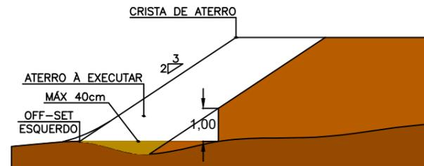
**3ª FASE** EXECUÇÃO DA 2ª CAMADA COM MATERIAL DE EMPRÉSTIMO OU CORTE. PROCESSAMENTO IDÊNTICO ATÉ QUE A LARGURA "L" SEJA A MÍNIMA NECESSÁRIA PARA OPERAÇÃO DO EQUIPAMENTO.
