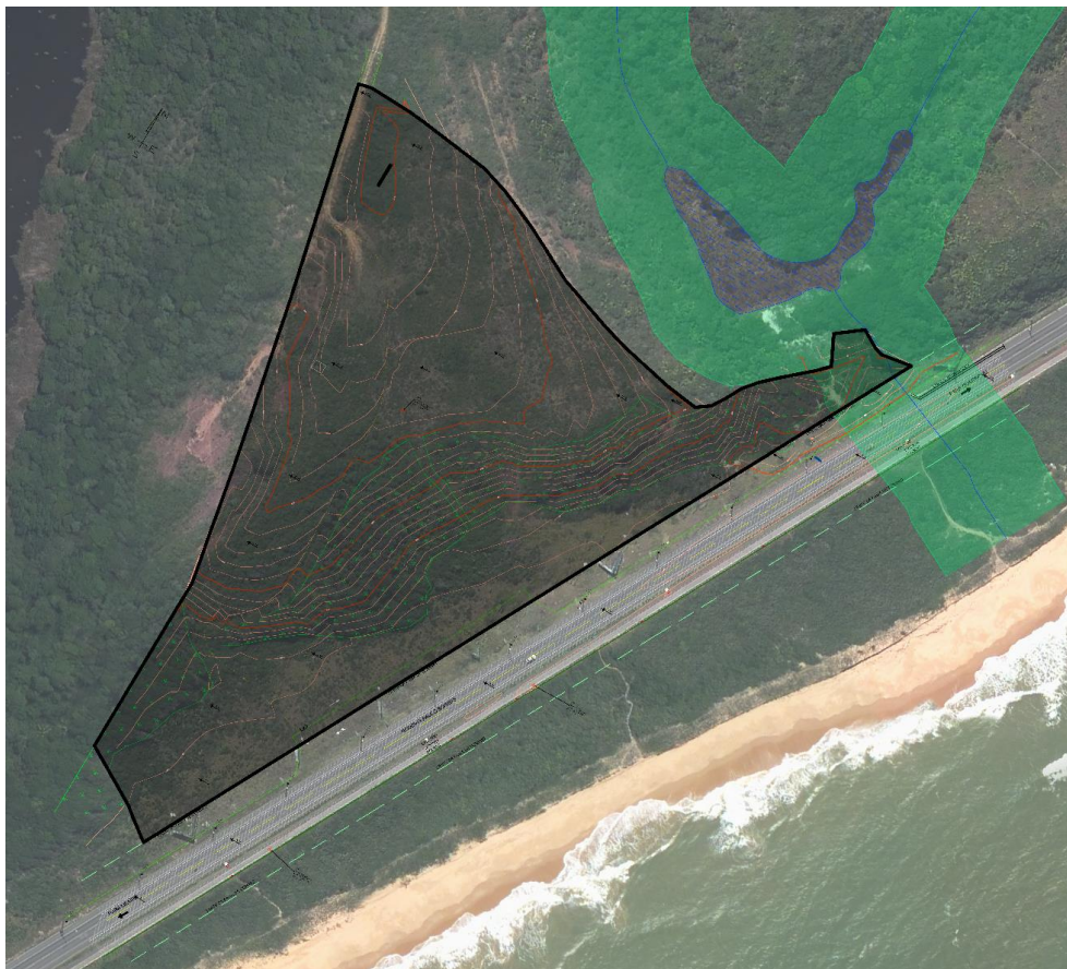
Figura 6: Fotografia aérea com indicação da área de contribuição do empreendimento.
