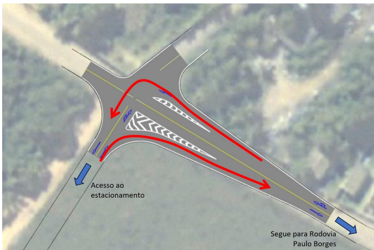
Figura 24: Detalhe da interseção 03 com indicação dos fluxos de chegada e se saída da via do estacionamento.
