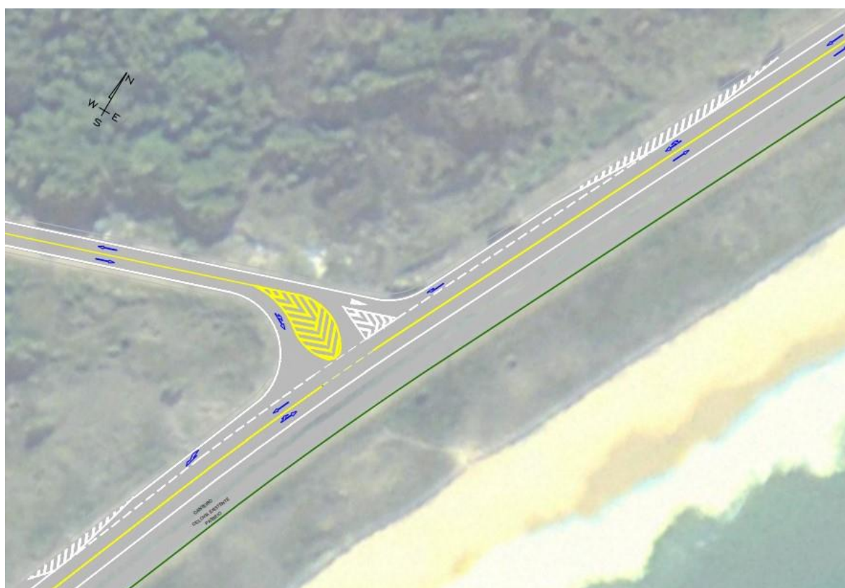
Figura 22: Detalhe da interseção 02 com estudo preliminar da sinalização horizontal.
